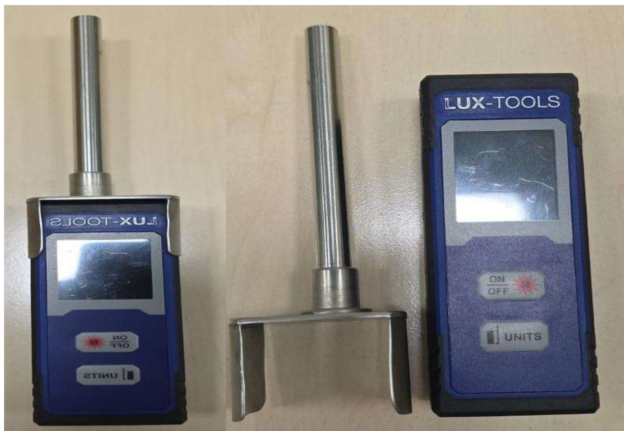
Рис. 1. Держатель лазерного дальномера (отдельно и в сборе)
