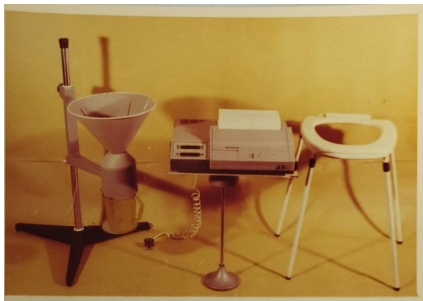
Рис. 4. Внешний вид урофлоуметра УФМ-1. (принцип работы ротационный диск)
