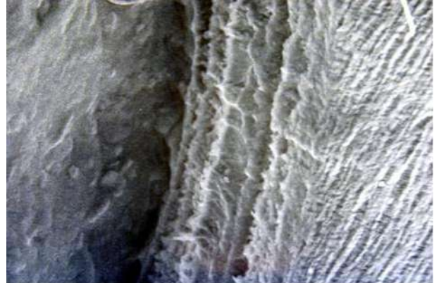
Рис. 16. Трёхслойная структура плёнки, борозды на поверхности, многослойная сердцевина. СЭМ x 500.
