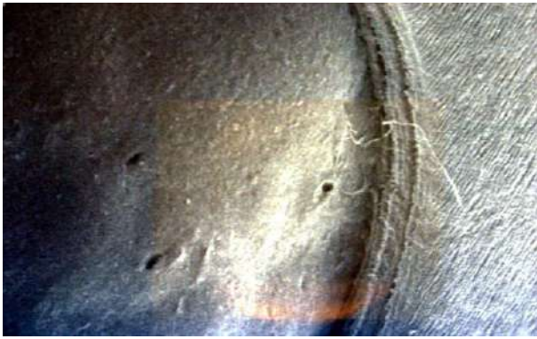
Рис. 15. Плёнка в месте расположения отверстия. Видна трёхслойная структура. СЭМ x100
