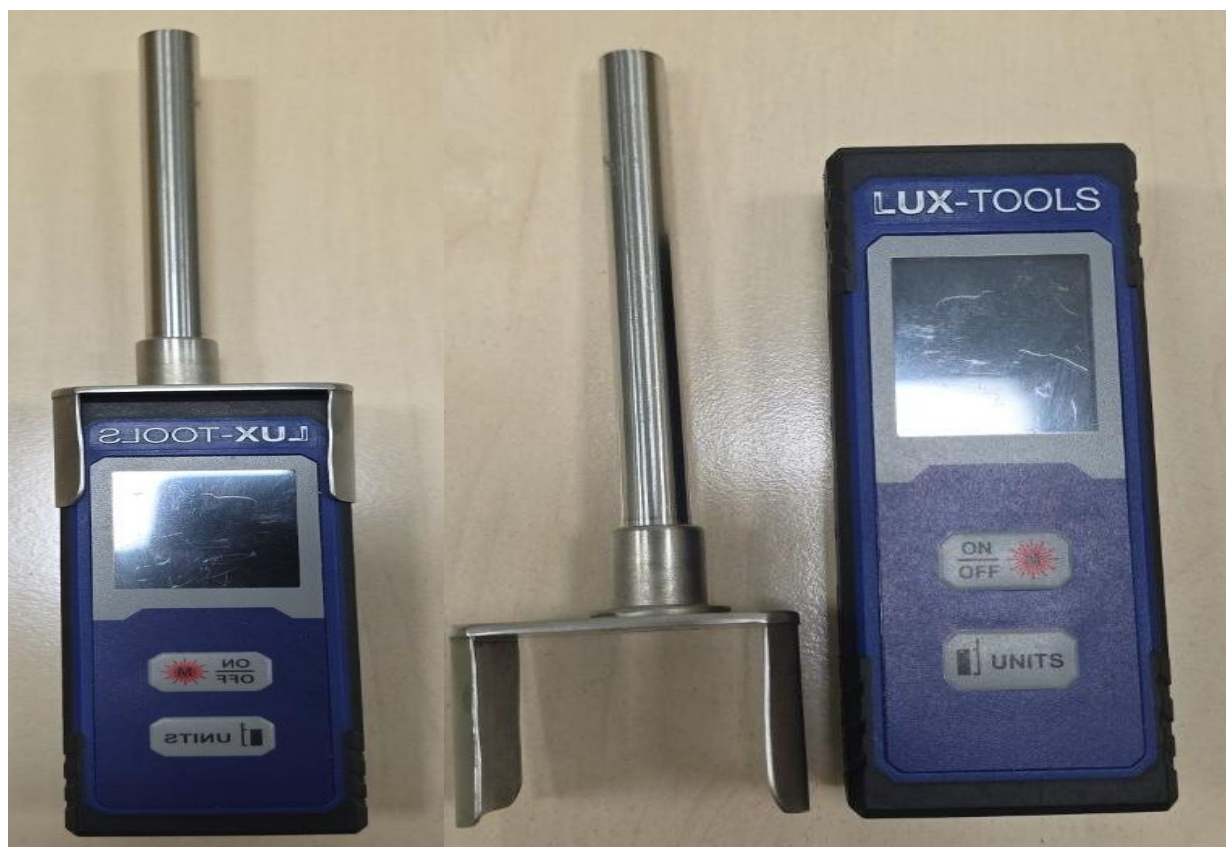
Рис. 1. Держатель лазерного дальномера (отдельно и в сборе)
