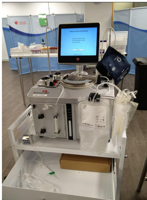
Рис. 1. Аппарат для плазмафереза (Scinomed, модель плазменного сепаратора) – с его помощью осуществлялось разделение крови и извлечение плазмы, которая затем обрабатывалась гипохлоритом натрия (НЭХО) и возвращалась пациенту.
