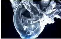
**Рис. 3.** Многочисленные дефекты разной формы на поверхности нити. СЭМ х 200.
