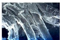
Рис. 5. Многочисленные глубокие повреждения разной формы на поверхности нити, отдельные дискретные образования. СЭМ х 200.
