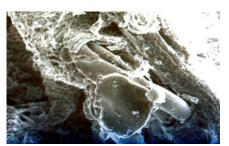
**Рис. 1.** Многочисленные дефекты на поверхности нити. СЭМ х 200.
