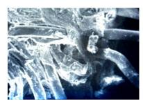
**Рис. 2.** Многочисленные дефекты разной формы на поверхности нити. СЭМ х 200.
